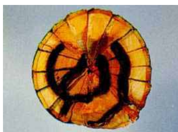
孔道の断面 変色した腐敗部
