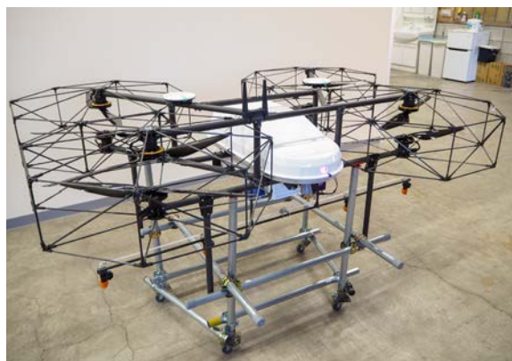
「Nile-T19」 安全性に配慮したプロペラガードは、創業当時の一貫した設計思想に基づく
