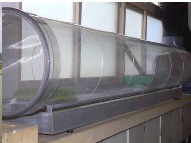
写真 8: 誘引試験に用いた風洞
