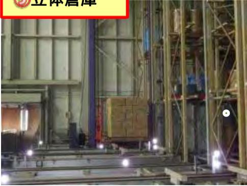
◀ 倉庫は5階建て相当の高さがあります。ここの操作も徹底したシステム化により、ロボットが全て自動で行います。
