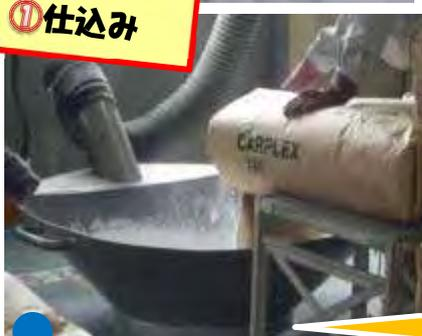
原料投入は手作業で行います。およそ直径60cmの穴へ原料を流し込み下の階の貯槽(ちようそう)に落とします。
