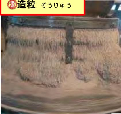
◀ 機械の中から外へ麺の様に細長い棒状の物が押し出されてきます。その後、解砕機（かいさいき）等で造粒物にカットします。
